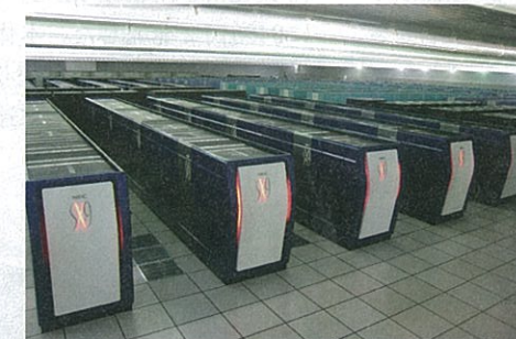
シミュレーションには、海洋研究開発機構の「地球シミュレータ」を活用している。全体で1280のCPUを備え、1秒間に131兆回の浮動小数点計算が可能 (提供 海洋研究開発機構)
